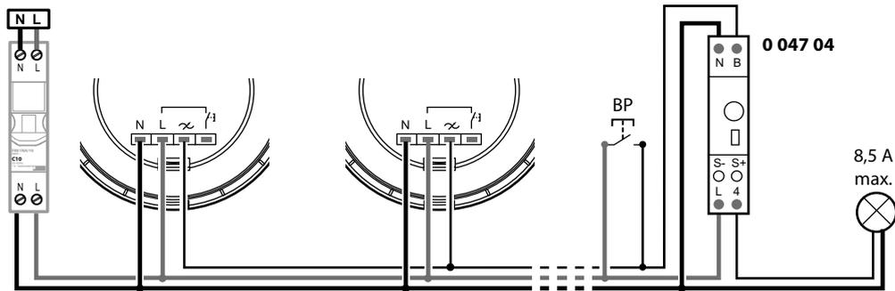
Collegando il sensore in questa maniera, il "tempo di ritardo" sarà regolato tramite timer esterno. Il parametro della "Funzione impulso" dovrà avere valore 0 (Vedere paragrafo 7. **Funzionamento**).
