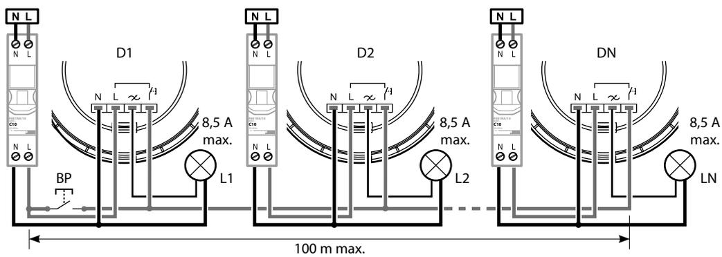
■ **4.3 Cablaggio in parallelo per un solo carico**
