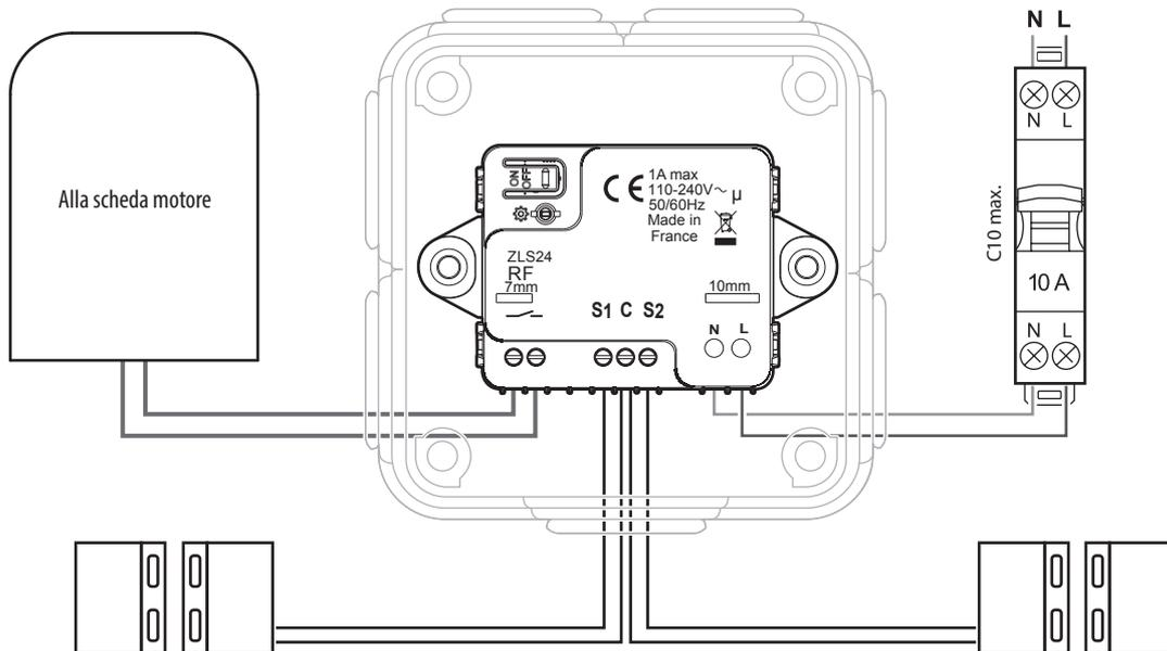
**ATTENZIONE:** Per funzionare in modo ottimale, il motore deve essere impostato in modalità passo-passo, consultare le istruzioni del costruttore. In questa modalità, il motore, ad ogni impulso ricevuto esegue il seguente ciclo: APRE-STOP-CHIUDE-STOP-APRE.
