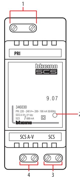
**ATTENZIONE: LE USCITE (SCS A-V) ED (SCS) POSSONO ESSERE UTILIZZATE CONTEMPORANEAMENTE RISPETTANDO L'ASSORBIMENTO MASSIMO TOTALE DI 600 MA.**
