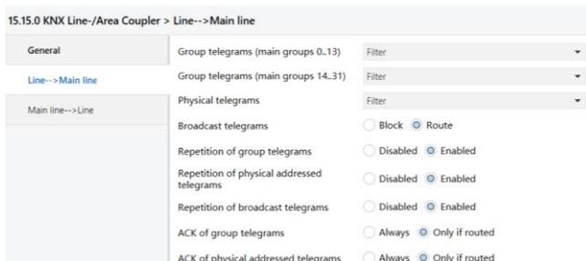
Fig.5.1.2 Parameter window "Line-->Main line"
