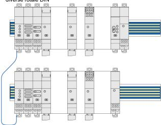
Moduli interconnessi tramite cavi di comunicazione sulla prima rotaia DIN e con una guida comunicante sulla rotaia DIN in basso.
