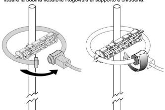
**Nota:** Installare le bobine Rogowski flessibili secondo la direzione indicata dalla freccia stampata sul nucleo della bobina.
