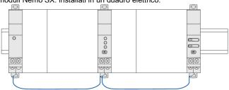
**Note installative:** con questa configurazione, la copertura in plastica delle porte di comunicazione sul retro del modulo di Nemo SX <u>deve</u> essere mantenuta in posizione.
