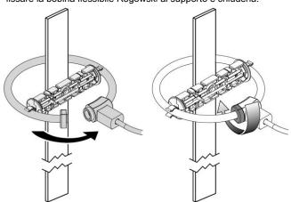
**Nota:** Installare le bobine Rogowski flessibili secondo la direzione indicata dalla freccia stampata sul nucleo della bobina.
