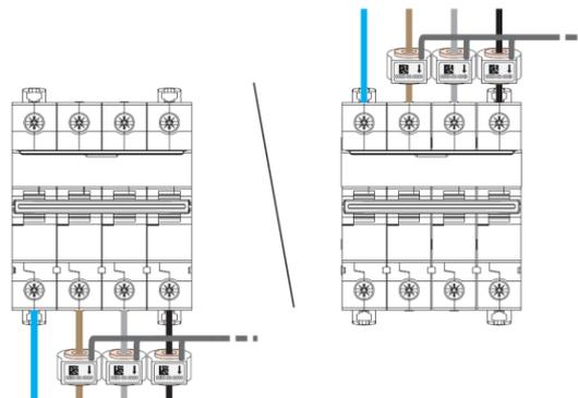
. Le bobine Rogowski devono essere inserite con la freccia posizionata nello stesso verso del flusso di corrente da misurare (freccia marcata sulla bobina).
