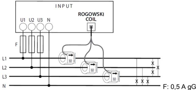
. La lunghezza del cavo dei sensori Rogowski (vedi § Dati Dimensionali) permette di installare il modulo di Misura Nemo SX ovunque nell'impianto. Questo implica che non è obbligatorio posizionare il modulo di misura vicino al dispositivo di protezione associato alla linea misurata.
