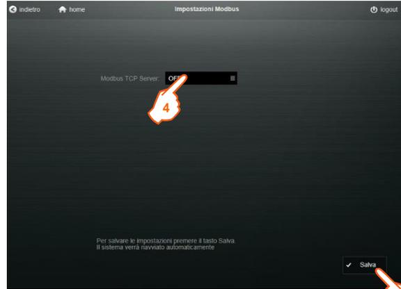
4. Cliccare per Abilitare (“ON”) il Server Modbus TCP utilizzato per la funzione Master/Slave
