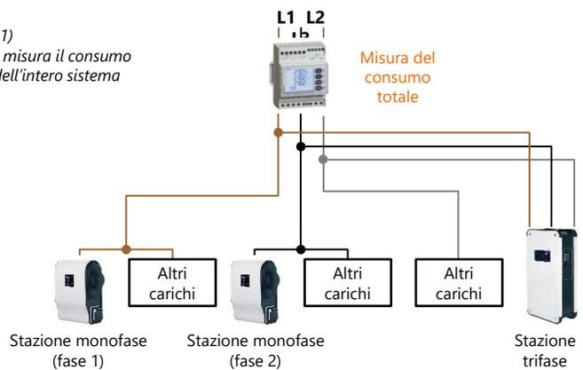
Questa configurazione consente di inserire le stazioni di ricarica in un'installazione esistente e favorisce i processi di ricarica perché il limite della corrente massima disponibile per la ricarica viene riposizionato dinamicamente in base al consumo di altri carichi.
