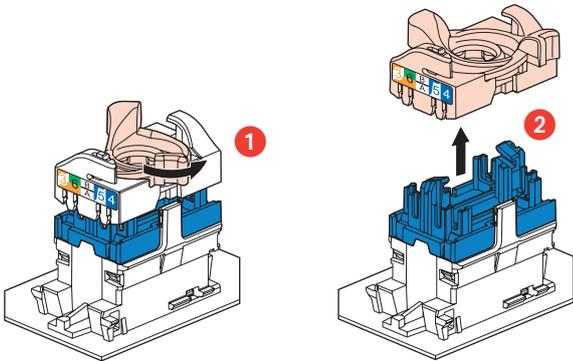
Questo sistema permette alle coppie di conduttori di essere separate prima di essere collegate ai connettori.
