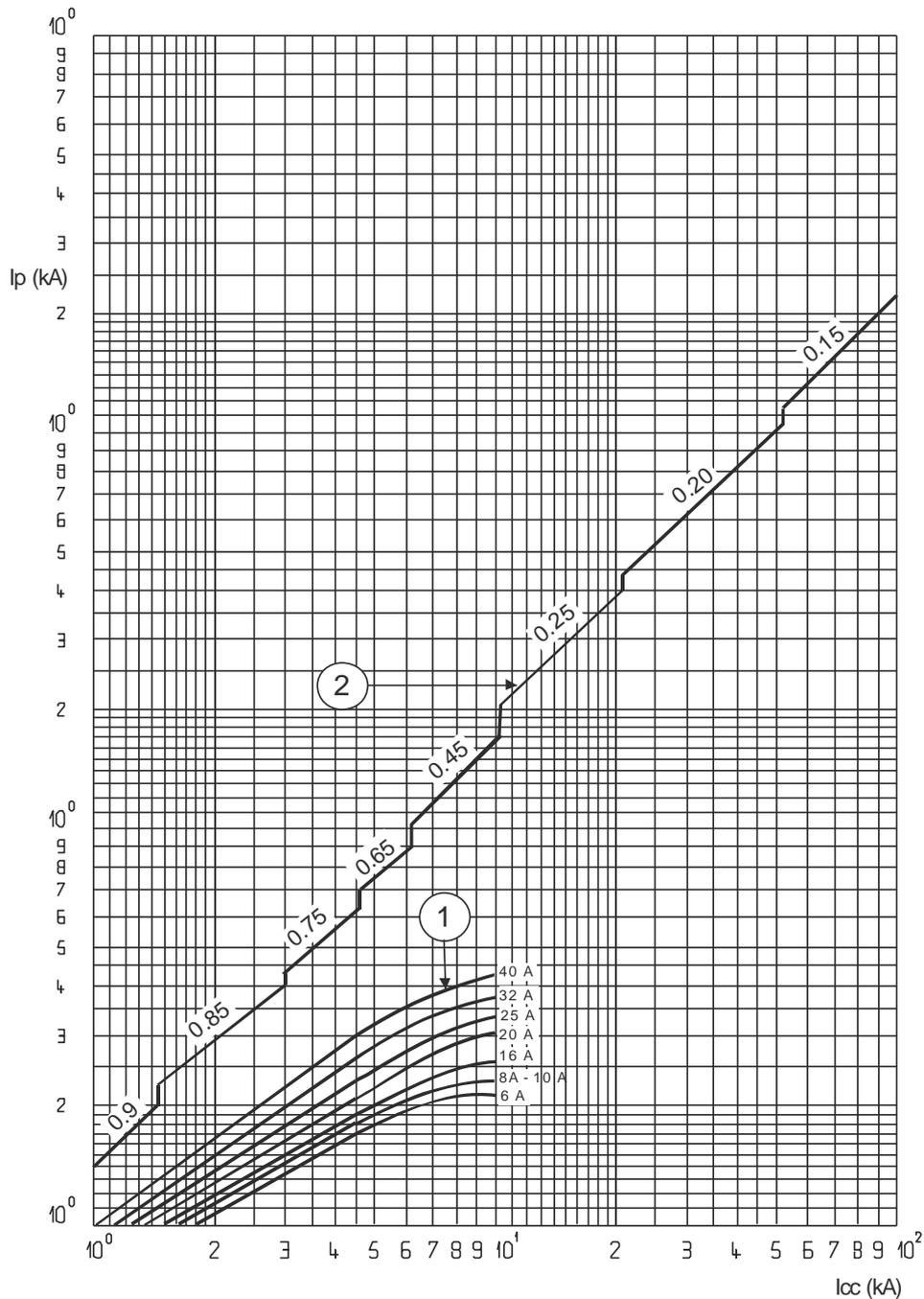
$I_{cc}$  = prospettiva corrente simmetrica di corto circuito (rms value in kA)
