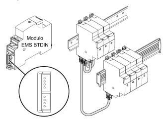
. Adattatore per giunzione cavi precablati:
