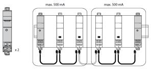
**Nota:** in un sistema (sotto una stessa interfaccia EMS/Modbus) è possibile utilizzare massimo 3 moduli di alimentazione = 3 gruppi da 500 mA
