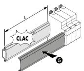
. Fissare il coperchio di protezione in plastica sulla parte esposta della rotaia comunicante
