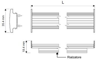
senza il profilo rialzatore per il montaggio su guide DIN di 7,5 mm di profondità
