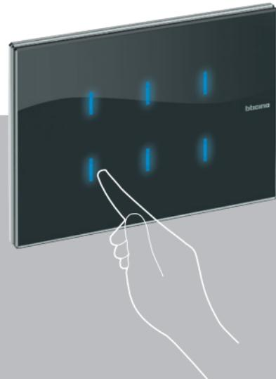
В середине каждой области кнопки находится синий светодиод; при прикосновении к этой области пальцем яркость свечения светодиода значительно увеличивается и сохраняется до тех пор, пока палец не будет убран.
