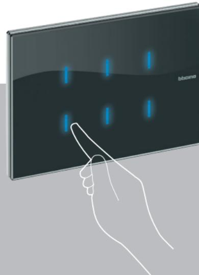
Jeder Bereich entspricht einer Taste, die in der Mitte durch eine hellblaue Leuchte markiert ist; wenn man sie mit einem Finger berührt, steigt die Intensität. Die Leuchte leuchtet solange stärker, bis der Finger entfernt wird. Das bestätigt zugleich, dass der Befehl gegeben worden ist.
