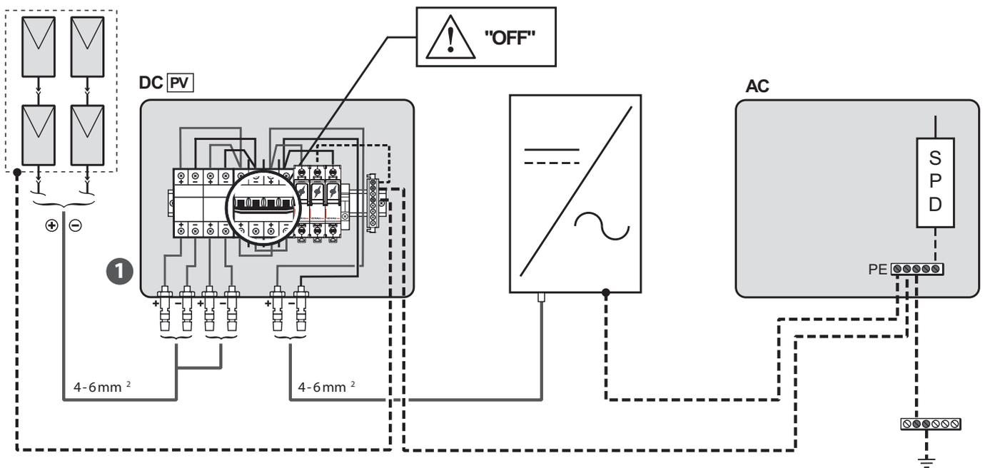
**1** Montare i connettori con i cavi dei pannelli fotovoltaici e dell'inverter (nei seguenti riquadri come collegare i connettori tipo MC4.)
