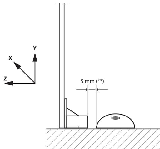
(\*\*) Dove possibile si raccomanda di installare alla distanza di 5 mm in linea con l'asse principale Z.
