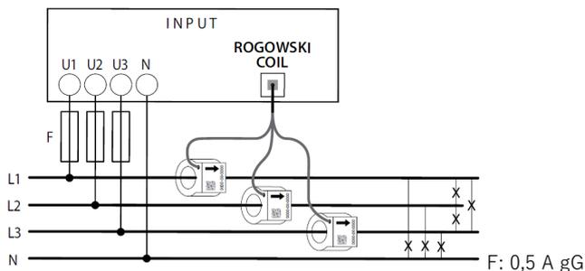
. La lunghezza del cavo dei sensori Rogowski (vedi § Dati Dimensionali) permette di installare il modulo di Misura Nemo SX ovunque nell'impianto. Questo implica che non è obbligatorio posizionare il modulo di misura vicino al dispositivo di protezione associato alla linea misurata.
