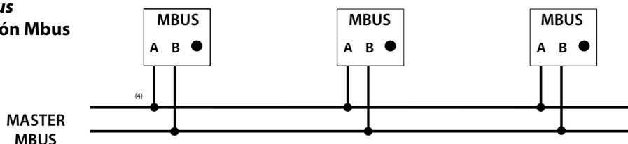
(4) Collegamenti non polarizzati. Un cavo telefonico standard a due fili (JYStY N°2\*0.8 mm)
