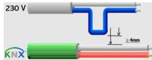
I conduttori non utilizzati del cavo bus non dovranno mai entrare in contatto con elementi sotto tensione o il conduttore di terra, stessa regola per la calza e anima interna dove presente. Il BX-TU sono tradizionali interfacce pulsanti a 4 ingressi, alle quali è stata aggiunta una sonda di temperatura per svolgere la funzione di Termostato.
