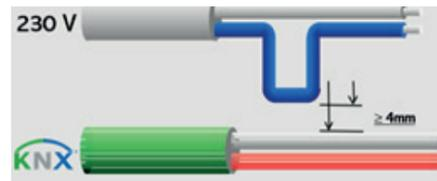
I conduttori non utilizzati del cavo bus non dovranno mai entrare in contatto con elementi sotto tensione o il conduttore di terra, stessa regola per la calza e anima interna dove presente.
