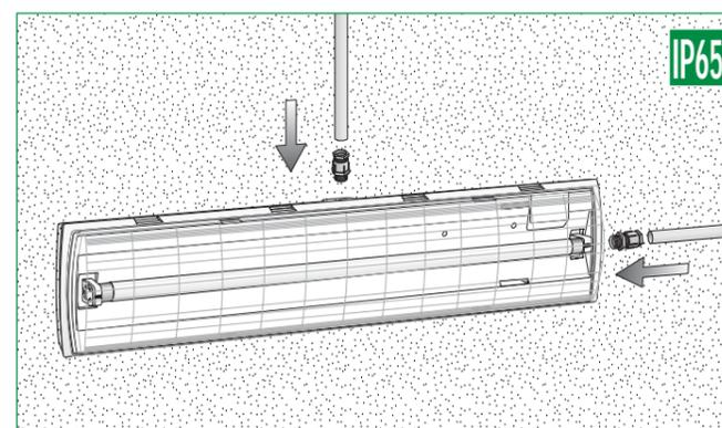
**INSTALLAZIONE CON TUBI DA Ø 16-20**
