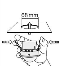
Nel soffitto si deve innanzitutto creare un'apertura circolare con un diametro di 68 mm.
