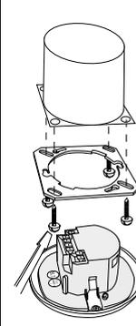
Il sensore può essere montato sul soffitto in scatole a incasso convenzionali.
