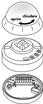
Il sensore deve essere montato su una base piana e solida. Prima del montaggio si deve rimuovere l'anello di protezione. A tale scopo si deve ruotare l'anello di circa 5° in senso antiorario e sollevarlo.
