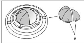
Se il campo di rilevamento del LUXOMAT® PD3N-1C è troppo grande o copre i campi che non devono essere sorvegliati, si può ridurre o limitare il campo a seconda del fabbisogno usando le clip di protezione in dotazione.
