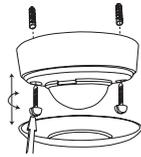
Il sensore deve essere montato su una base piana e solida. Non occorrono telai sopra traccia o scatole a incasso. Prima del montaggio si deve rimuovere l'anello di protezione. A tale scopo si deve ruotare l'anello di circa 5° in senso antiorario e sollevarlo.
