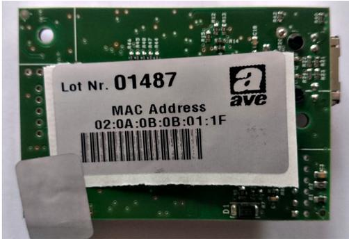
Unitamente al cavo di programmazione la scheda è fornita di un'etichetta riportante il MAC ADDRESS. Tale etichetta deve essere rimossa dalla scheda ed applicata all'interno del box delle centrali AF949PLUS o AF999PLUS in modo che sia visibile in caso di manutenzione e/o cambio di parametri di impostazione dell'impianto.
