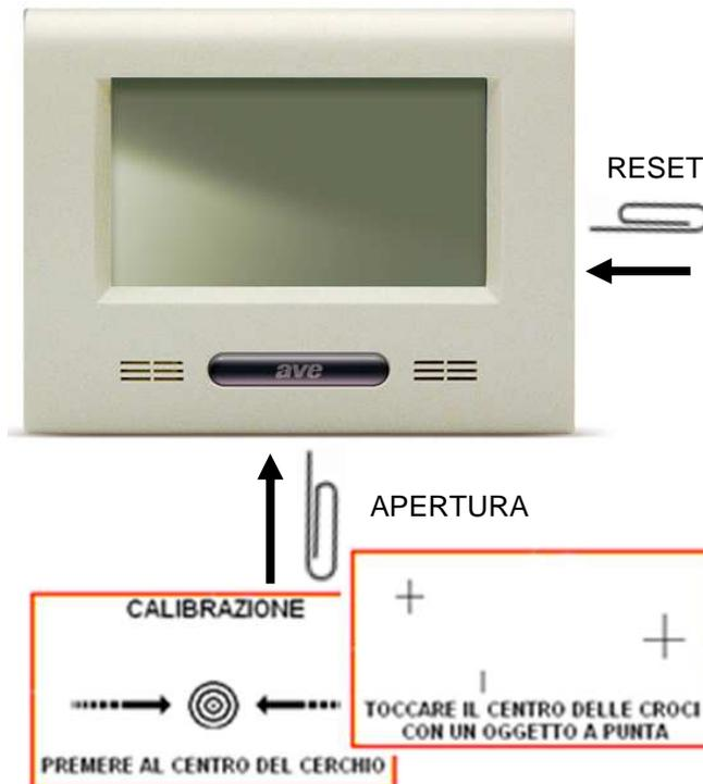
**Apertura del box:** la tastiera si apre premendo con un fermaglio come indicato in figura e separando il coperchio dal fondo.
