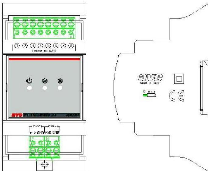
Il prodotto 53BSA232 è un'interfaccia che permette di collegare un personal computer (PC) al bus domotico utilizzato dai dispositivi della serie Domina (AVEBus), attraverso una porta seriale RS-232.
