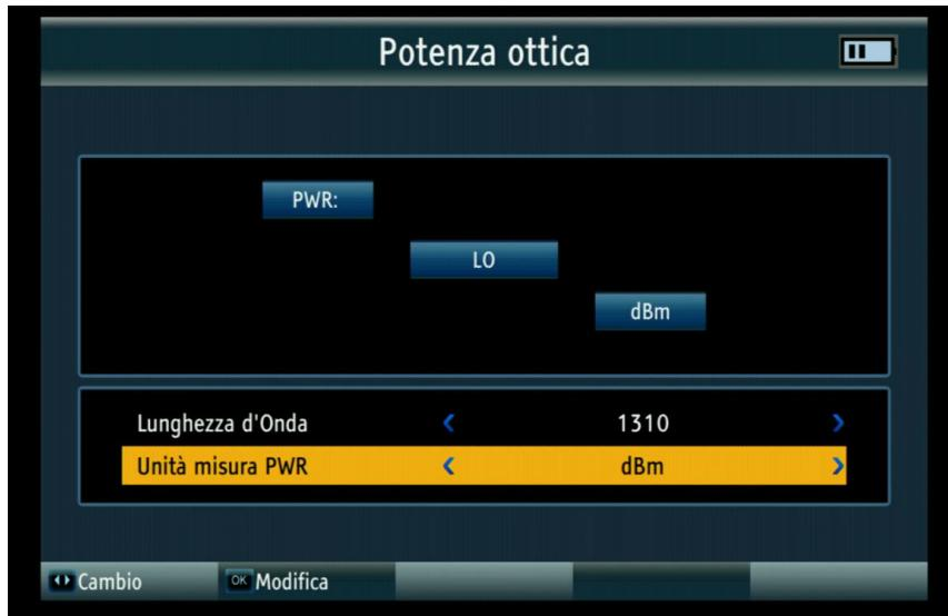
Collegando all'ingresso ottico dello strumento una sorgente di segnale, è possibile misurare la potenza ottica dei segnali di una rete, selezionando la Lunghezza d'onda (850, 1300, 1310, 1490, 1550, 1625) e l'unità di misura della potenza (W, dBm). La misura viene mostrata in basso
