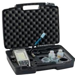
1 pH-mètre C.A 10101 livré en mallette durcie avec 1 électrode de pH combinée avec capteur de température intégré XRGST1, 4 piles alcalines AA ou LR6, 1 gaine de protection montée sur l'appareil, 2 solutions tampons (conformité à NIST/DIN) prêtes à l'emploi de pH 4,01 et 7,00, 2 béciers en plastique, 1 cordon USB - micro USB, 1 dragonne, des guides de démarrage rapide (un par langue).
