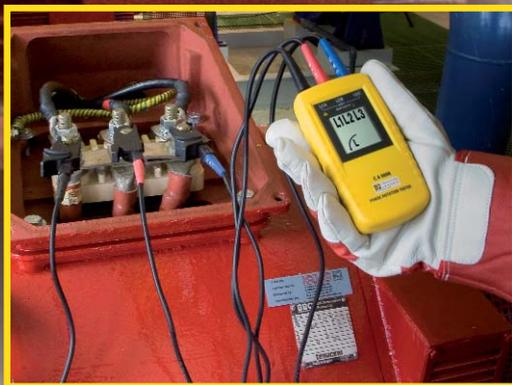
Les **C.A 6608** et **C.A 6609** sont des instruments essentiels pour identifier l'ordre des phases d'une installation électrique et le sens de rotation de tout équipement industriel raccordé à cette installation. Complètes et simples d'utilisation grâce au repérage couleur des bornes et câbles, ces appareils sont parfaitement adaptés pour les services de contrôle et de maintenance des bâtiments industriels.
