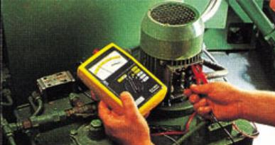
Contrôle de l'isolement des enroulements d'un moteur.
