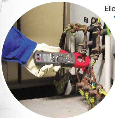
Elle dispose d'un **afficheur 10 000 points rétro-éclairé**, d'une mémorisation d'affichage, des fonctions **mesure de la valeur maxi.** et **mesure différentielle** (Delta). Pour garantir une bonne autonomie, elle est dotée de **l'extinction automatique**, en cas de non-utilisation prolongée de l'appareil.
