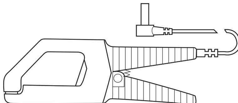
(1) Conditions de référence : 23 °C ± 5 °K, 20 % à 75 % HR, 48 Hz à 65 Hz, champ magnétique extérieur < 40 A/m, pas de conducteur proche parcouru par un courant, conducteur centré, impédance de charge 0,1 Ω.
