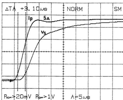
(1) Conditions de référence : 23°C ± 3°K, 20% à 75% HR, signal sinusoïdal de fréquence 48 Hz à 1 kHz, champ magnétique extérieur < 40 A/m, absence de composante continue, absence de conducteur extérieur parcouru par un courant, conducteur mesuré centré, impédance de charge > 1 MΩ / < 100 pF.
