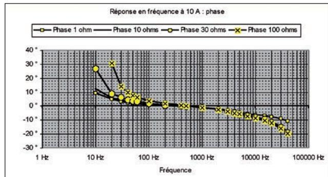
(1) Conditions de référence : 23 °C ± 3 °K, 20 °C à 75 % HR, signal sinusoïdal de fréquence 48 Hz à 10 kHz, facteur de distorsion < 1 % avec absence de composante continue, champ magnétique extérieur continu < 40 A/m, absence de champ magnétique alternatif extérieur, absence de conducteur extérieur parcouru par un courant, conducteur mesuré centré, impédance de l'appareil de mesure charge ≤ 10 Ω.
