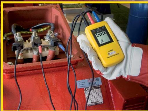
**C.A. 6608** e **C.A. 6609** sono strumenti essenziali per identificare l'ordine delle fasi di un impianto elettrico e il senso di rotazione di qualsiasi apparecchiatura industriale collegata all'impianto. Completi e di semplice utilizzo grazie all'identificazione colorata di morsetti e cavi, questi apparecchi sono perfettamente adatti per i servizi di controllo e di manutenzione degli edifici industriali.
