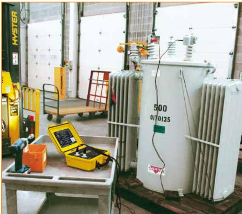
Il DTR® 8510 è un ratiometro digitale portatile progettato per controllare i trasformatori di potenza, potenziale e corrente. Collegato ad un trasformatore fuori tensione, il DTR® permette di misurare precisamente il rapporto fra il numero di giri d'avvolgimento del primario e il numero di giri d'avvolgimento del secondario, visualizzando anche la polarità e la corrente d'eccitazione.
