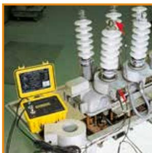
Misura del rapporto di un trasformatore di corrente
