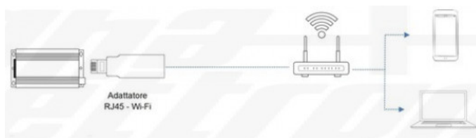
Collegamento a inverter serie KIPT con interfaccia RJ45/RS485
