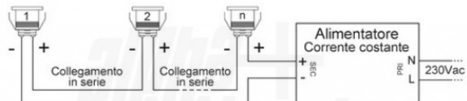
Schema di collegamento di più faretti in serie
