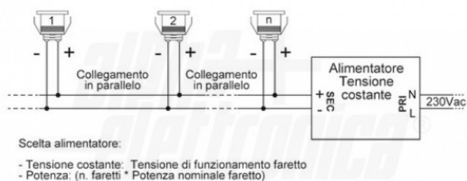
Schema di collegamento di più faretti in parallelo
