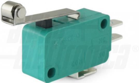
Micro-Interruttore finecorsa - Miniatura - Deviatore - A leva con rotella - SPDT - 16A@250Vac, 10A@125Vac - (ON)/ON - 3 terminali faston 4,8 - Attuatore: Ottone nichelato
