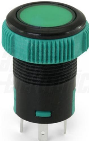
Pulsante - Interruttore - Bistabile - Luminoso: si - Luce: Verde - 20Vdc - Verde - SPST - 20A@12Vdc - ON/OFF - 3 terminali faston 4,8 - 18mm x ø19.2mm - Attuatore: Plastica - IP67
