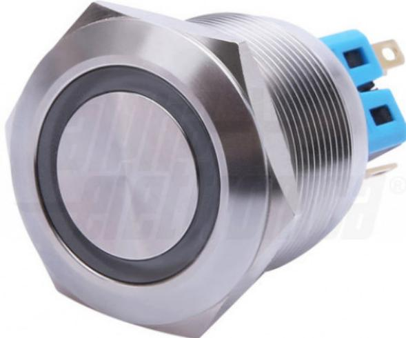
Pulsante - Antivandalo - Interruttore - Bistabile - Luminoso: si - Luce: Rosso - 24Vac/dc - Lucido - SPST - 5A@250Vac, 5A@36Vdc - 2 x N.C. + 2 x N.A. - 10 terminali a saldare - ø25mm - : Acciaio inox 304 - Attuatore: Acciaio inox 304 - IP65
