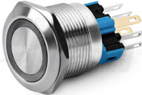
Pulsante - Antivandalo - Interruttore - Bistabile - Luminoso: si - Luce: Blu - 24Vac/dc - Metallo - SPST - 5A@250Vac, 5A@36Vdc - N.C. + N.A. - 6 terminali a saldare - ø22mm - : Acciaio inox 304 - Attuatore: Acciaio inox 304 - IP65
