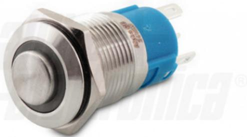
Pulsante - Antivandalo - Interruttore - Bistabile - Luminoso: si - Luce: Giallo - 24Vac/dc - Lucido - SPDT - 5A@250Vac, 5A@36Vdc - ON/ON - 5 terminali a saldare - ø16mm - : Acciaio inox 304 - Attuatore: Acciaio inox 304 - IP65
