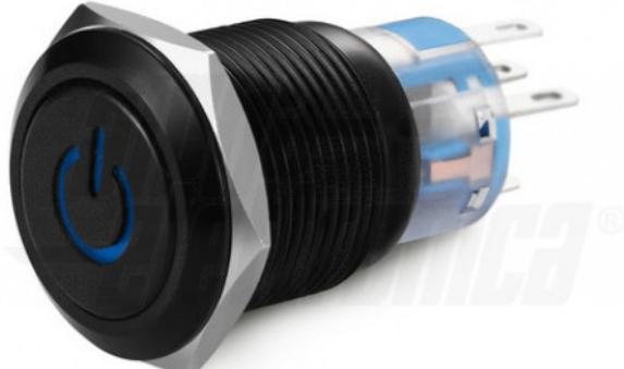
Pulsante - Antivandalo - Interruttore - Bistabile - Luminoso: si - Luce: Blu - 12Vac/dc - Nero - SPDT - 5A@250Vac, 5A@36Vdc - ON/ON - 5 terminali a saldare - ø19mm - : Zn-Al - Attuatore: Zn-Al - IP67
