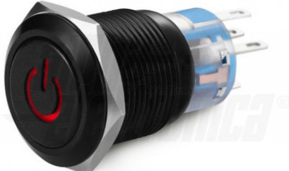
Pulsante - Antivandalo - Interruttore - Bistabile - Luminoso: si - Luce: Rosso - 12Vac/dc - Nero - SPDT - 5A@250Vac, 5A@36Vdc - ON/ON - 5 terminali a saldare - ø19mm - : Zn-Al - Attuatore: Zn-Al - IP67
