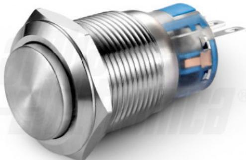
Pulsante - Antivandalo - Interruttore - Bistabile - Luminoso: no - Lucido - SPDT - 5A@250Vac, 5A@36Vdc - ON/ON - 3 terminali a saldare - ø19mm - : Acciaio inox 304 - Attuatore: Acciaio inox 304 - ip65
