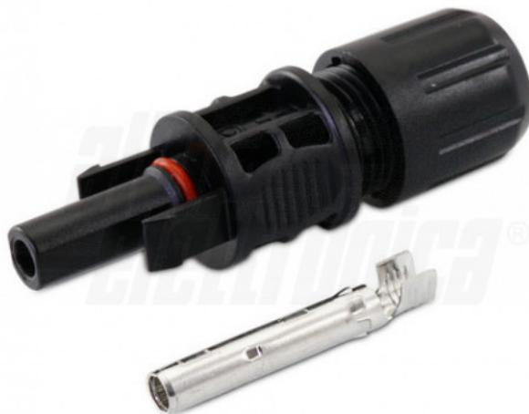
Connettore Fotovoltaico - Femmina - 1500V - a crimpare - Volante - 4-6mm<sup>2</sup>
