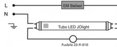
2 - Installazione con ballast Elettronico HF o
