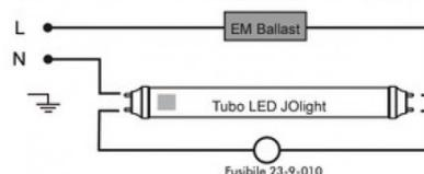
2 - Installazione con ballast Elettronico HF o nuova installazione
