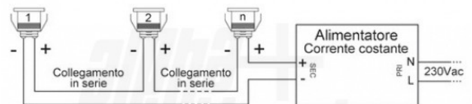
Schema di collegamento di più faretti in serie
