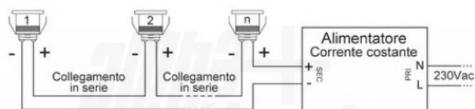
Schema di collegamento di più faretti in serie
