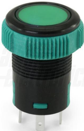
Pulsante - Pulsante - Monostabile - Luminoso: si - Luce: Verde - 12Vdc - SPST - 20A@12Vdc - OFF/(ON) - N.A. - 3 terminali faston 4,8 - 18mm x Ø19,2mm - Attuatore: Plastica - IP67
